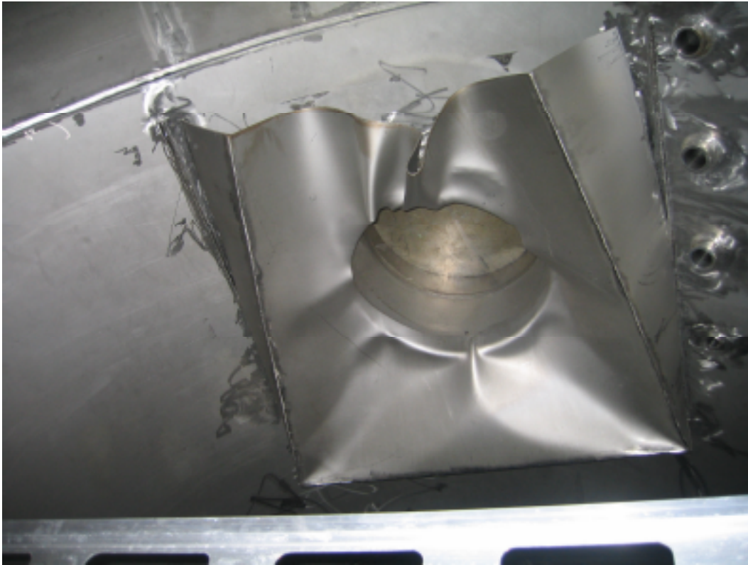
Figur 6 Hullet i deflektorplaten
