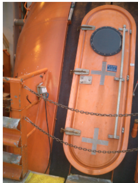
Figur 5 Viser inngang til livbåt med kontakt og ladekabel
